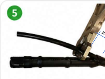
5 Découpe à 30mm du haut du réservoir
